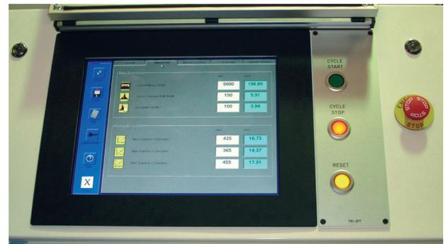
**Triflex** 推瓶机适用于高速生产线，由于这台设备控制上的灵活可变，它绝对是化妆品容器和制药容器等不稳定容器生产商的首选递送设备。它可以与最高速度达**36米**每分钟的横向输送机配套生产。具备多种可选功能，例如电气控制可调式扶瓶杆机构，为需要额外扶持的易倒容器而设计。这台设备有强大的工作信息储存库，减少开机设置时间和停机时间。
